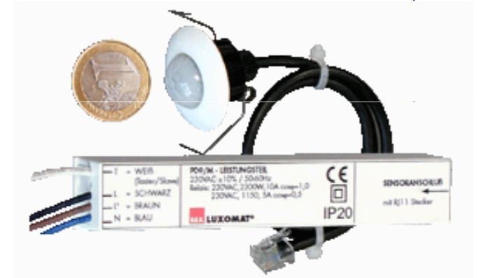
**Durch diese Einbaugeräte wird das Licht bei erkannter Bewegung und Überschreitung einer vorgegebenen Mindesthelligkeit (Einschaltwert) automatisch eingeschaltet sowie bei fehlender Bewegung oder Überschreiten einer vorgegebenen Maximalhelligkeit (Ausschaltwert) abgeschaltet. Die Lampenleistung wird je nach Tageslichteinfall gedimmt und auf einem einstellbarem Wert konstant gehalten.**
